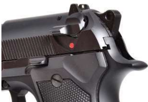
Pistola Beretta serie 92. Si nota la sicura manuale che, oltre ad interrompere la catena di scatto, ha la funzione "abbatticane"
