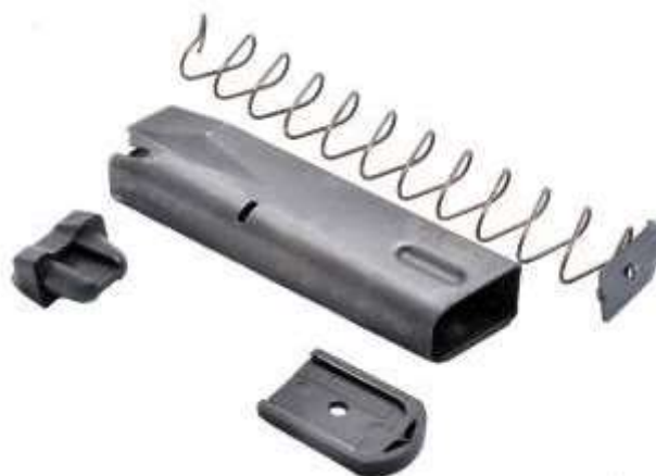
Smontaggio di un serbatoio
